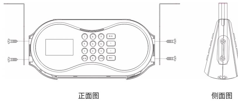
2、再将铁挂板用螺丝固定到支架上。
