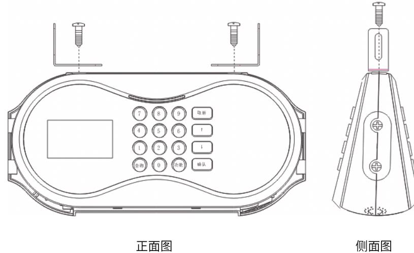
2、再将铁挂板用螺丝固定到支架上。
